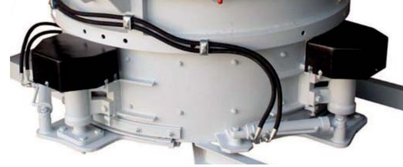
ÇİFT TARAFLI MİKSER ALT HİDROLİK BOŞALTIMA KAPAÇI DOUBLE SIDE BOTTOM HYDRAULIC DISCHARGE GATES
