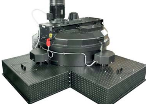
KOMPLE KAPAKLI ve MUHAFAZALI ALT BOŞALTIMA OLUKLARI COMPACT FRAME, OPENABLE CEMENT INLET.
