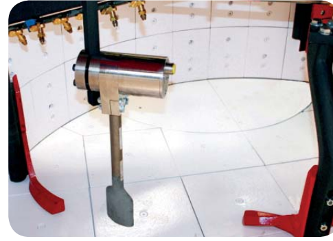
DONER KOLLEKTORLU YÜKSEK HASSASİYETLİ NEM ÖLÇME SİSTEMLERİ MOISTURE MEASUREMENT SYSTEM TITH COLLECTOR AND HIGH SESITIVITY.
