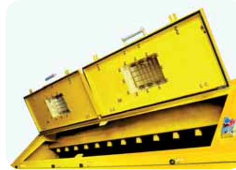
MİKSER BAKIM KAPAKLARI EŞİT ŞEKİLDE MİKSER İÇİ DAĞITICI SU TESİSATI MIXER INSPECTION HATCHES HOMOGENOUS WATER DISTRIBUTOR.
