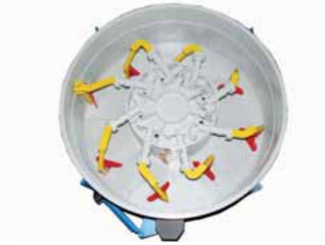
GÖVDE ETRAFINDA HOMOJEN KARIŞTIRAN YAYLI PALETLER SPRING PALLETS ON FRAME FOR HOMOGENOUS MIXING
