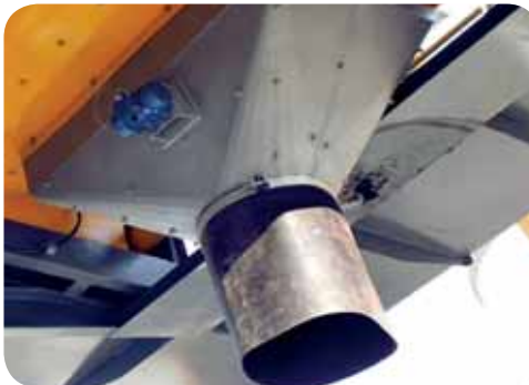
AŞINMA PLAKALI ve TİTREŞİMLİ ALT BETON BOŞALTIMA OLUĞU VIBRATING BOTTOM DISCHARGE CHUTE WITH LININGS
