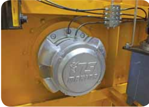
SIZDIRMAZ ARA BOŞLUKLU DÖKÜM YATAKLAMA LEAKPROOF STEEL CAST BEARINGS.
